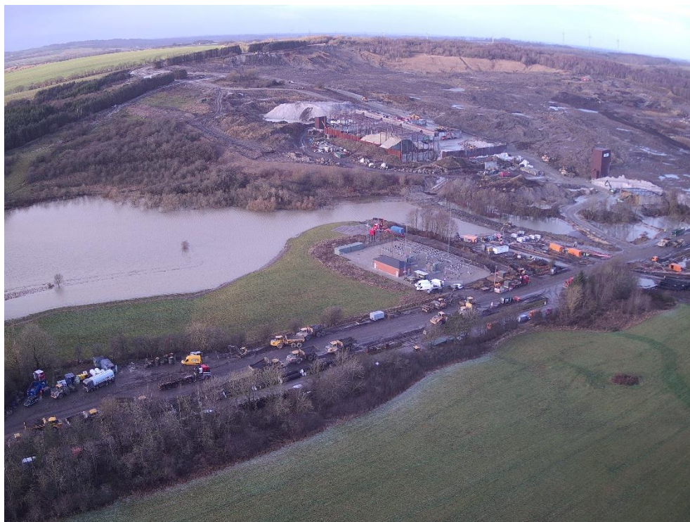
Billede 1: Området set fra sydøst. Alling Å, hvor vandet er rent, er gået over sine breder. Vandet inde på arealet er forurenet. Vandområderne er adskilt med en dæmning, som lige er opført. Der pumpes vand fra Alling Å i rør over til den eksisterende Alling Å lige syd for Ølst by. Jordskredet kan ses øverst til højre. Området ligger fra kote 75 ned til kote 20. Det har faldet mod Alling Å og landevejen Gl. Århusvej.
